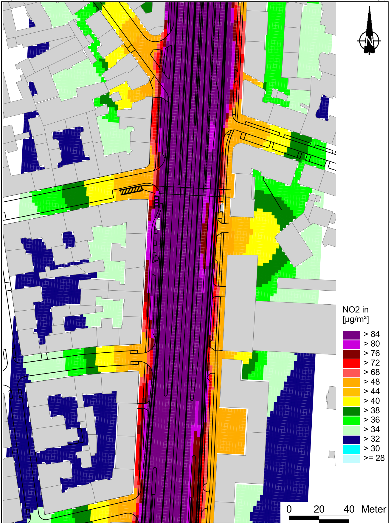
Abb. 6.2: NO 2 -Gesamtbelastung (Jahresmittelwerte) im Ist-Zustand 2011 in ca. 1.5 m Höhe ausgedrückt in \mu\text{g}/\text{m}^3 . Gebäude sind hellgrau und Straßen als schwarze Linien eingezeichnet
