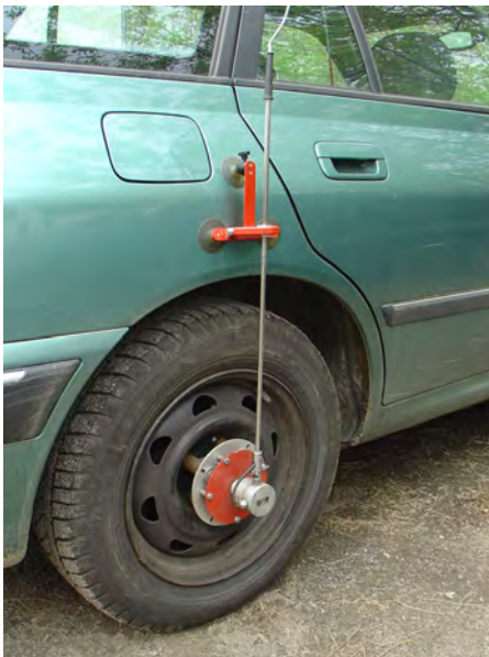
Abb. 5.1: Messfahrzeug mit angebautem Peiseler-Messrad
