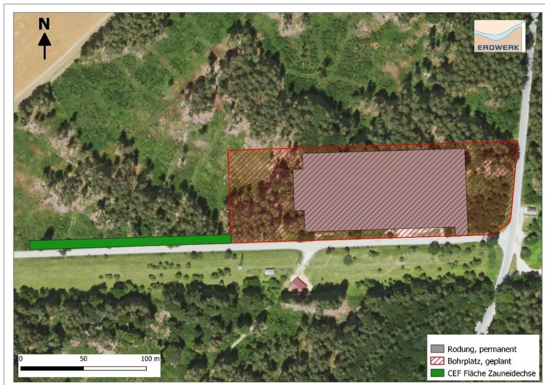
*Abbildung 4: CEF-Fläche für die Zauneidechse (grünes Rechteck) mit permanenter Rodungsfläche (grau) und Fläche des Bohrplatzes (rot schraffiert) am Standort Laufzorn II (Luftbild: Google Satellite Status Abruf 12/2023)*
